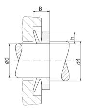
Axial fastening d4 min. =  $\emptyset$ d + 0,5 x h
